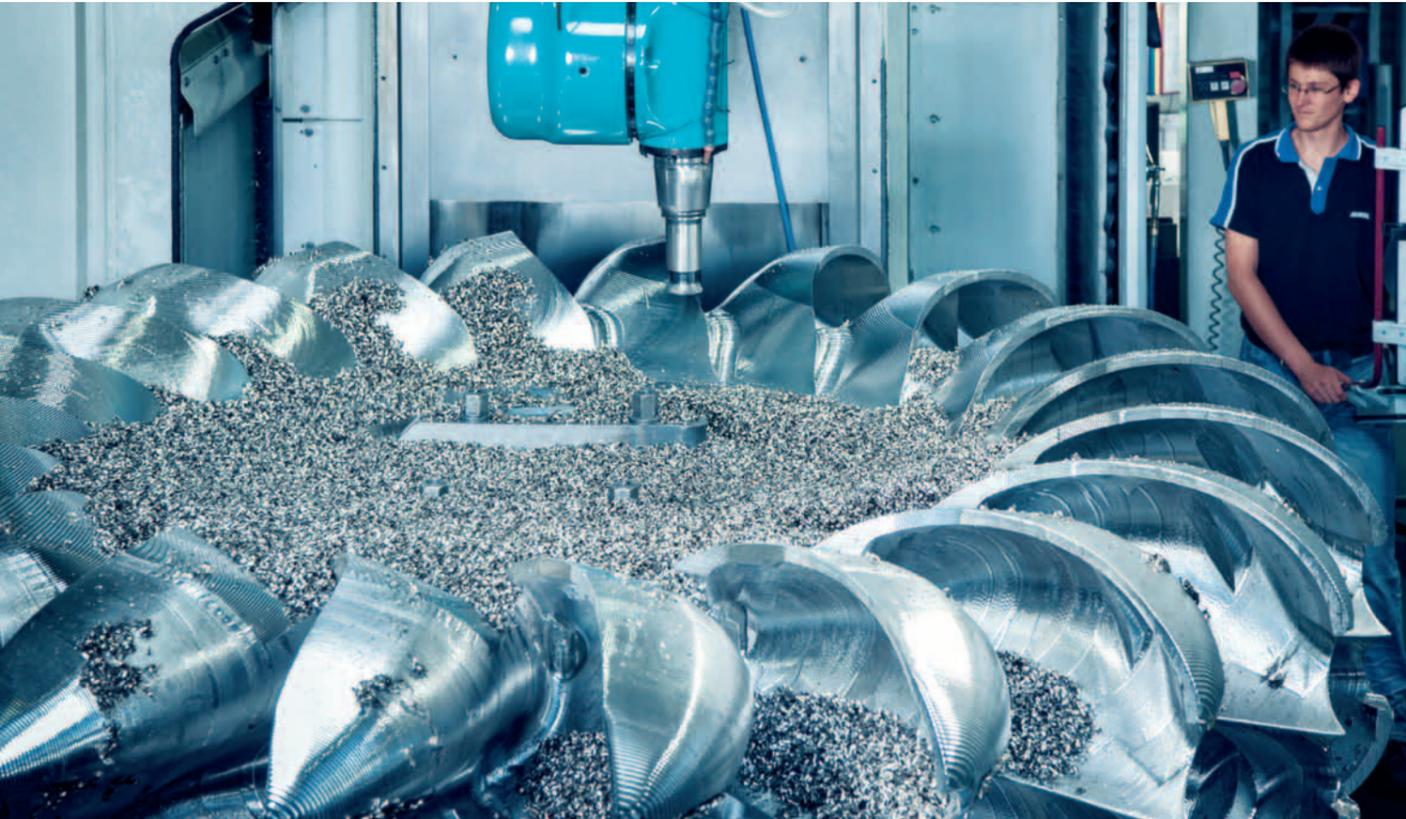
In der Mechanischen Fertigung werden hochwertige und komplexe Bauteile mit anspruchsvollen Qualitäts- und Genauigkeitsanforderungen spanabhebend bearbeitet.
