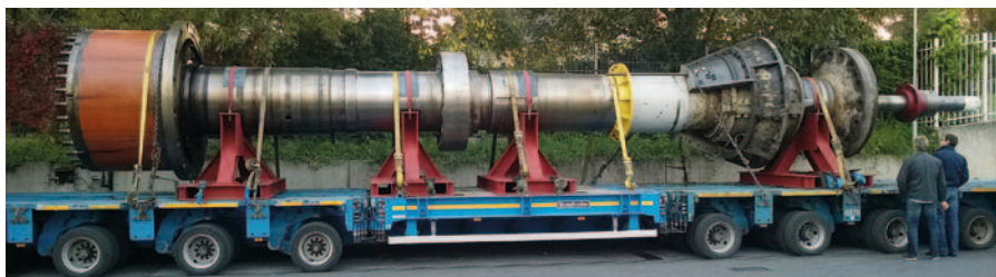
▲ Transporte do eixo de linha (comprimento: 14,8 m, peso: 95 toneladas)
