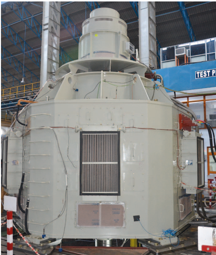
▼ Gerador da UHE de Kal durante o teste
