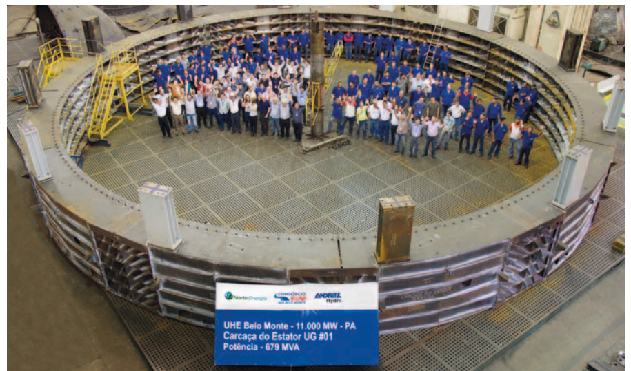
▼ UHE Belo Monte - estator em fabricação
