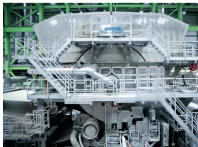
◀St. Croix指定用于两台纸机的大型扬克缸（直径18英尺）
