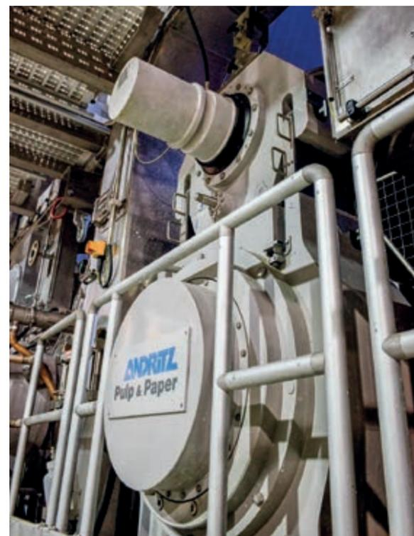
▲安德里茨PrimePress X的靴压，维护量极低，满足了Iggesund Workington纸厂高质量箱板纸所需的松厚度和干度。
