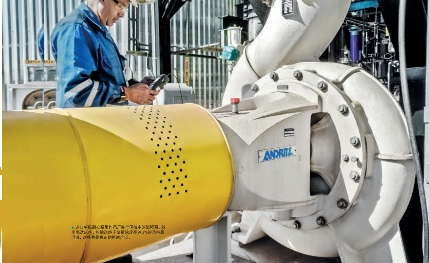
▲ 这些单级离心泵用作浆厂各个区域中的流程泵。效率高达90%，能输送绝干浆量浓度高达6%的浆料悬浮液，这些泵是真正的用途广泛。
