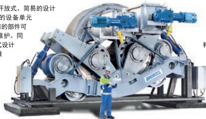
挤压后的物料达到比较高的干度。传统的挤压脱水机通常情况下可以使年平均物料干度达到40%，在正常运行情况下，HQ-Press树皮挤压脱水机可以使物料的年平均干度达45%。设备单元的先进控制可以在各种操作条件下实现产出最大化。HQ-Press采用稳健、可靠的设计理念，可以适用于任何原木堆场的树皮或者生物物料的处理。
