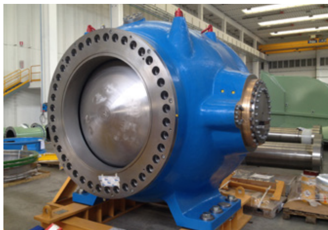
Vanne en fabrication, Grand'Maison, vallée de la Romanche
