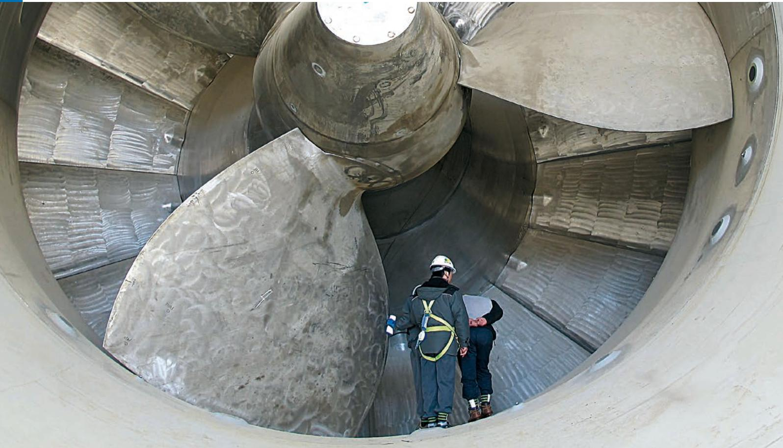
**«АНДРИТЦ ГИДРО» – мировой лидер по производству капсульных турбин, на долю которого приходится более 70% мирового рынка.** Капсульные турбины – горизонтальные поворотно-лопастные турбины, отличающиеся невероятной эксплуатационной гибкостью. Малая или большая мощность, русловая или приливная ГЭС, наличие или отсутствие редуктора, постоянная или регули-
