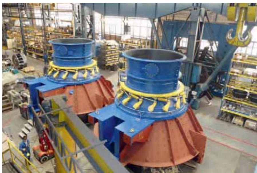
Les turbines Compact axiales bulbe de la CHE de Lixhe lors des travaux d'assemblage en atelier
