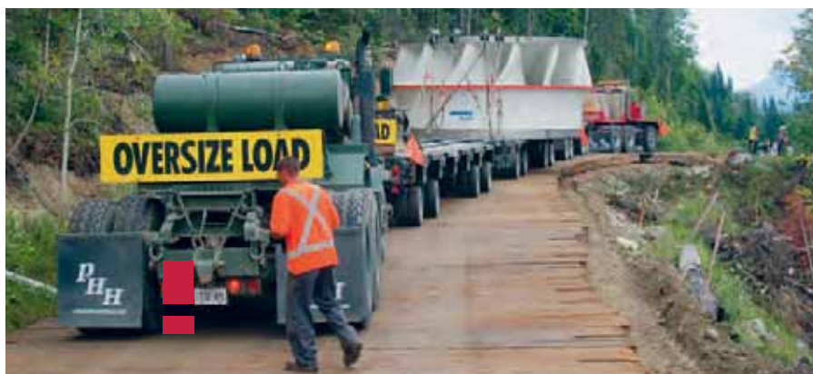
□ Livraison de la roue de 520 MW pour l'unité 5 de la CHE de Mica en Colombie Britannique
